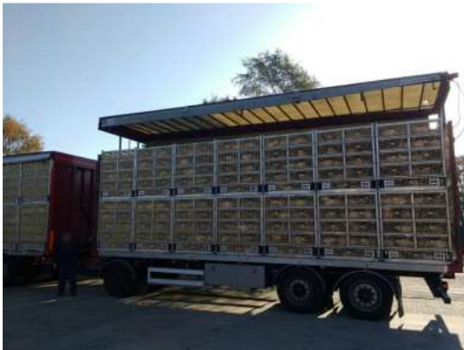
Σχήμα 2.4 Τα φορτηγά μπορεί να έχουν οροφή που μπορεί να ανυψωθεί ώστε να αποφευχθεί η καταπόνηση λόγω ζέστης.
