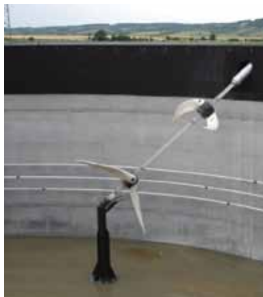
Σχήμα 7.23: Αναδευτήρες κρεμασμένων πτερυγίων (αριστερά) και η αντίστοιχη μηχανή ανάδευσης (δεξιά) (AGRINZ 2006)
