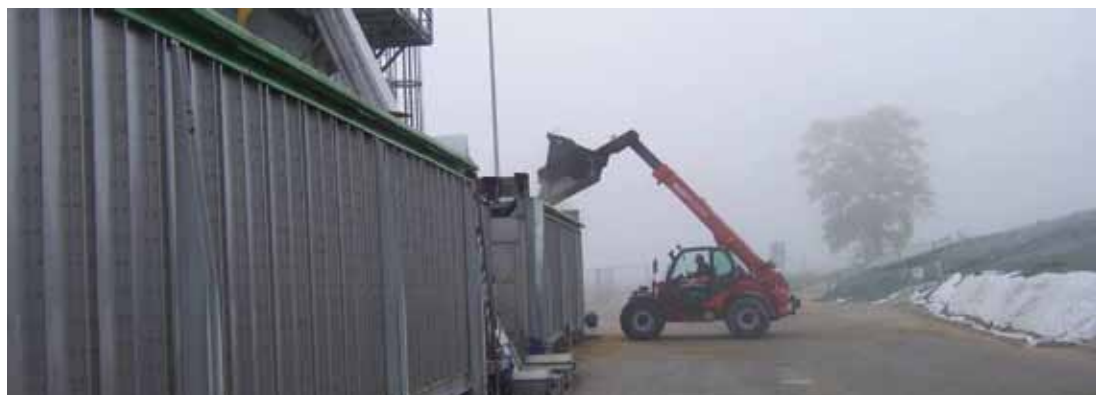
Σχήμα 7.11: Φορτωτής που αδειάζει χορτονομή αραβοσίτου μέσα σε ένα κοντέινερ (RUTZ 2008)
