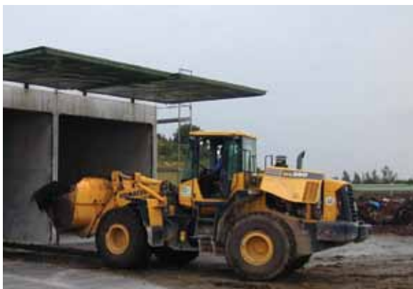
Σχήμα 7.18: Χωνευτής τύπου γκαράζ, τροφοδοτούμενος από φορτωτή (BEKON 2004)
