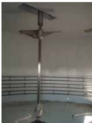
Σχήμα 7.23: Αναδευτήρες κρεμασμένων πτερυγίων (αριστερά) και η αντίστοιχη μηχανή ανάδευσης (δεξιά) (AGRINZ 2006)
