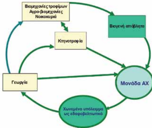
Σχήμα 4.9: Απεικόνιση του κλειστού κύκλου AX σε κεντρικές μονάδες (AL SEADI 2001)
