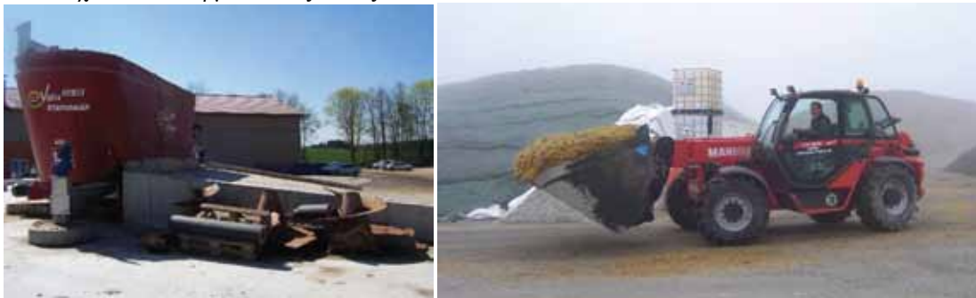
Σχήμα 7.10: Σύστημα κιβωτίων τροφοδοσίας για ξηρή πρώτη ύλη χορτονομή αραβοσίτου και στερεή κοπριά πουλερικών (αριστερά) και μηχανήμα φόρτωσης με χορτονομή αραβοσίτου (δεξιά) (RUTZ 2008)
